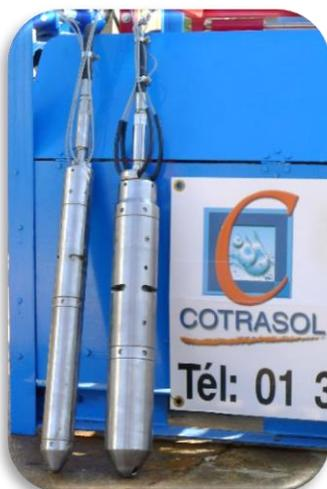
COTRASOL dispose de deux générateurs d'impulsions AIRSHOCK afin de traiter de façon optimale des forages ayant des crépines allant de **140mm** à **500mm** de diamètre.
